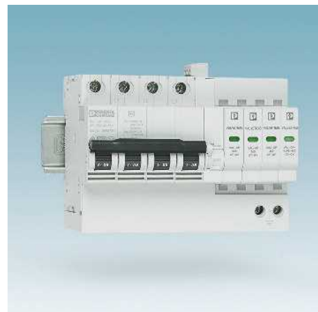
电涌保护器，内置后备保护熔断器 VAL-CP-MCB...由II类电涌保护器和内置抗电涌的后备保护熔断器组合而成。
