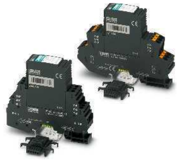
5线保护, 用于现场总线和串行接口, 9/10通过气体放电管接地
