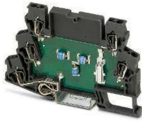
双导线（环路），浮地，例如，用于执行器电路
