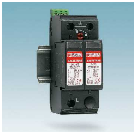
II类电涌保护器，适用于高电压场合 对于高电压电源，如风电系统中，或者要求单通道放电电流大于30 kA时，可选用VAL-MS...系列电涌保护器。
