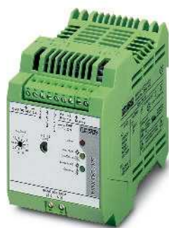
内置电源的UPS, 100 - 240 V AC / 24 V DC, 2 A
