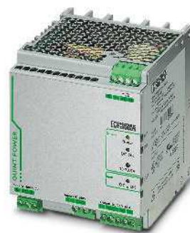
用于变频器的电源，带两个单独的输入电路，2 AC, 1 DC/24 V DC, 20 A
